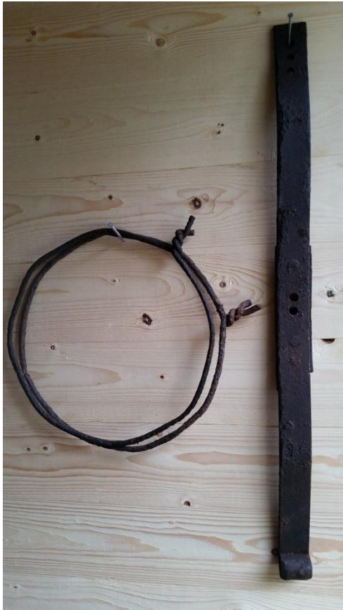
Strammejern: Et heimelaga verktøy av et langt dørhengsel ble brukt til å løsne og stramme jernringene på rørgata ettersom stavene trutnet eller gisnet.
