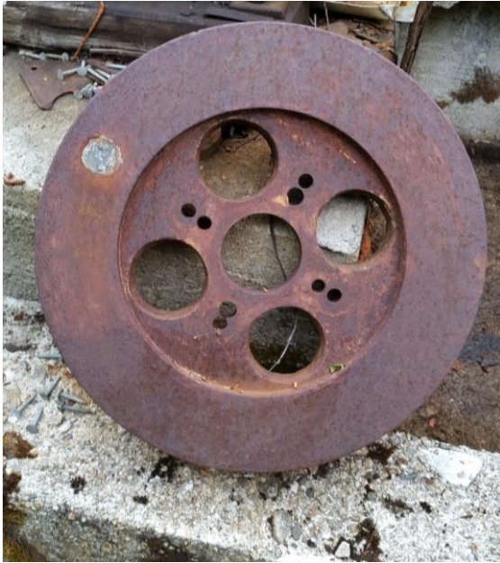
Svinghjulet med innstøpt bly for balansering.
